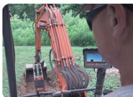
L'avantage de l'iDig est que vous connaîtrez la position de la dent de votre godet au cm près en permanence quelque soit la position de la flèche ou du balancier et en temps réel.
